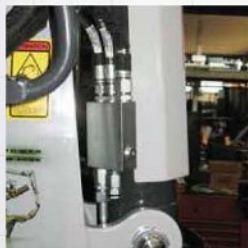
Dispositivi di sicurezza con valvole overcenter sul cilindro distributore di momento e sensori sugli stabilizzatori. Safety devices with over-center valves on the cylinders, load current limiter and sensors on the stabilizers.
