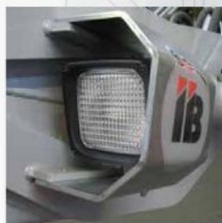
Fari di lavoro protetti e azionabili dal posto guida disponibili anche a led. Protected working lights which can be activated from the driver's seat.
