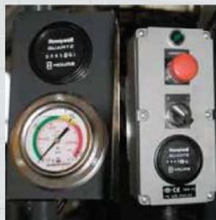
Equipaggiamento di sicurezza con manometro ad indicazione del sovraccarico, dispositivo di arresto d'emergenza, contatore, sensore uomo-presente nel sedile e protezioni per leve di comando. Safety equipment with manometer indicates overload, emergency stop device, time meter, presence detection sensor on the seat and protections for control levers.
