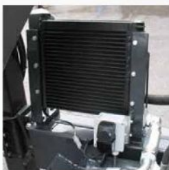
Scambiatore di calore automatico con centralina proporzionale per mantenere il circuito idraulico a temperatura costante. Automatic heat exchanger with proportional control unit to maintain the hydraulic circuit at a constant temperature.
