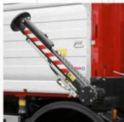
Stabilizzatori telescopici orientabili a 180°. Disponibili anche con ribaltamento idraulico a catena. Telescoping stabilizers with rotation at 180°. Also available with hydraulic tilting chain device.
