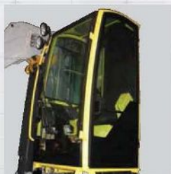
Postazione di comando con cabina protetta ad elevata visibilità, dotata di tutti i comfort di serie e rialzabile idraulicamente. Disponibile anche la versione oc. Driver's seat with high visibility protected cabin equipped with all modern conveniences as standard supply that can be hydraulically lifted up. Also available version left.
